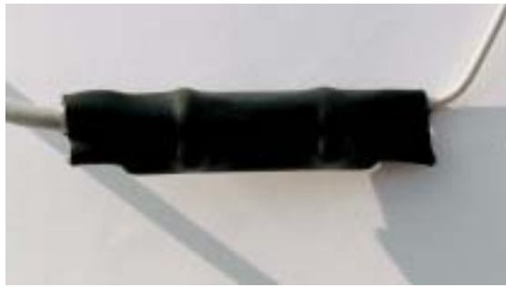
▲ Die Interfaceelektronik des neuen USB-Interfaces ist durch einen dicken Schrumpfschlauch gegen Umwelteinflüsse geschützt
