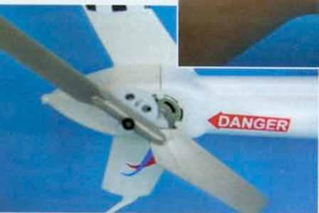
▲ Der Heckrotor mit Antriebsmotor und Getriebe
