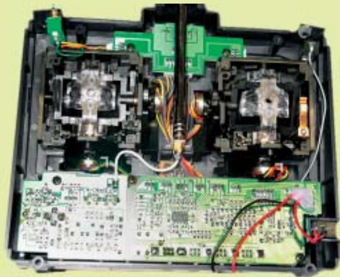
Der mitgelieferte Handsender ist recht gut verarbeitet. Der Schalter links oben wurde zusätzlich eingebaut
