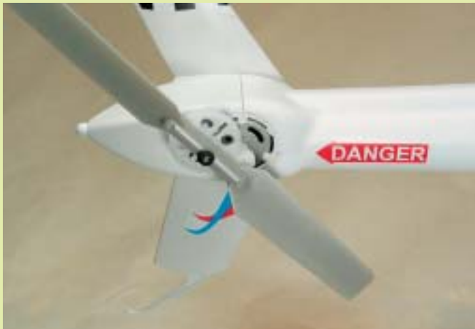
Der Heckmotor treibt über ein Getriebe den fest eingestellten Heckrotor an. Die eigentliche Steuerung erfolgt durch Drehzahländerung.
