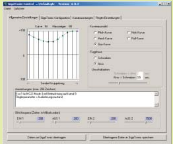
Die Gaskurvendarstellung der Acro-Einstellung anhand der PC-Software für die Gigatronik
