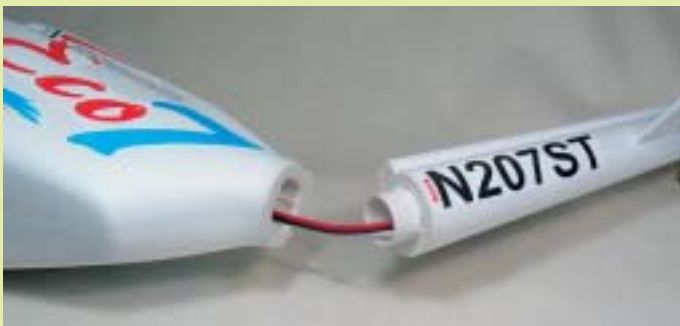
Der Bajonettverschluss des Heckauslegers erlaubt einen schnellen Ersatz nach einem Crash
