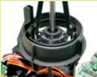
Die ringförmige Führung für den Taumelscheibenaußenring dient auch als Führung für die Mechanik innerhalb des Rumpfes
