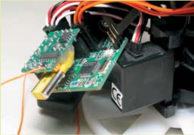
Die Gigatronic mit PC-Anschluss. Oben ist der Empfänger mit Standard-Quarz aufgesteckt.
