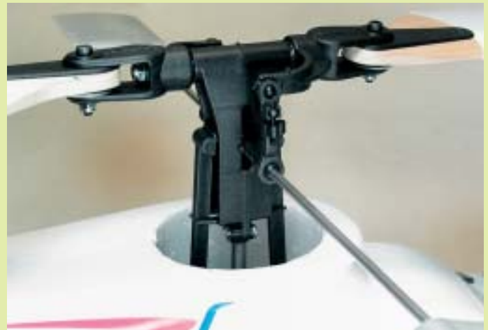
Der Kollektiv-Rotorkopf ist extrem einfach und übersichtlich aufgebaut
