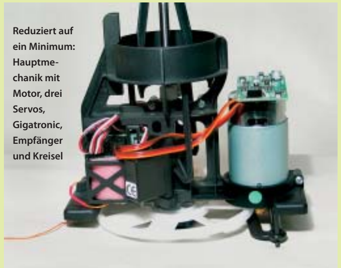
Das Powerboard auf dem Hauptmotor beinhaltet das Leistungsteil für Haupt- und Heckmotor sowie das BEC für die Empfängerstromversorgung
